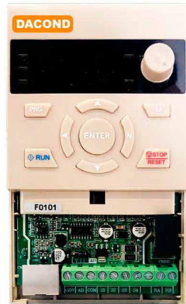
Рис 1 Система ввода/вывода гибко выбирается за счет сменной интерфейсной панели (примеры):
